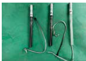
溶断及び過電流が流れたヒューズ
